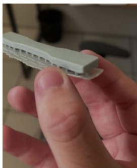
Figura 5: Corpo de prova do compósito de resina com espinélio
