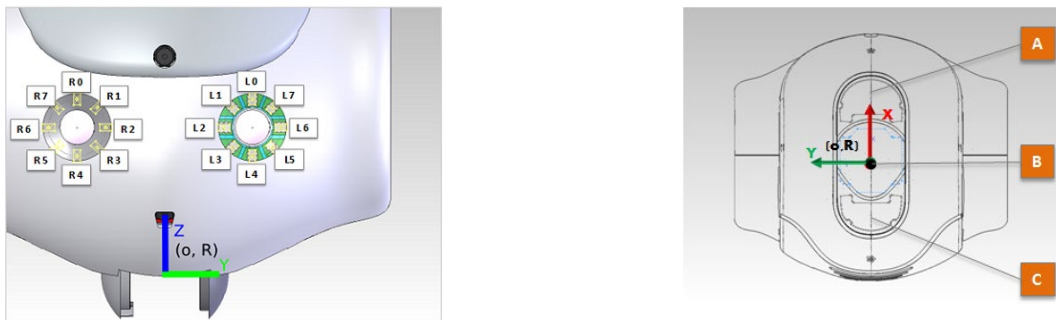
Figura 1 - LEDs oculares e sensores táteis na cabeça do robô
