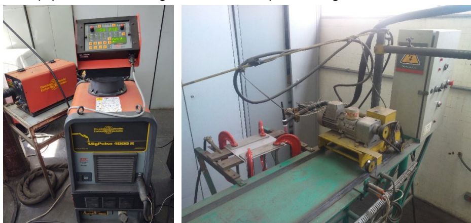
Figura 1 - Equipamento de soldagem TIG utilizado para soldagem e o sistema automatizado
