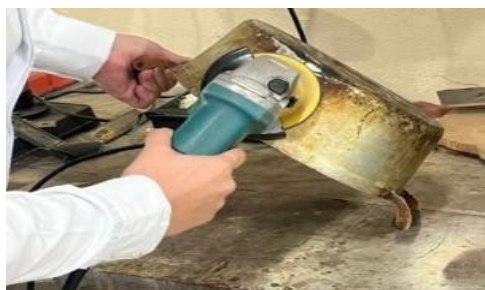
Figura 1 - Lixamento da panela
