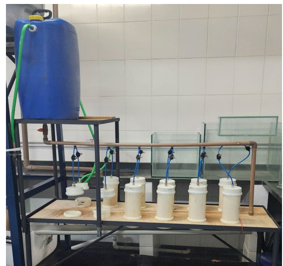
Figura 1 – Equipamento patenteado pelo autor: (a) Projeto do equipamento; (b) Corpos de prova colocado no equipamento para teste de autocicatrização.
