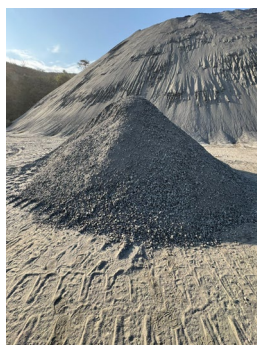
Figura 3 – Amostra de brita graduada simples (BGS).
