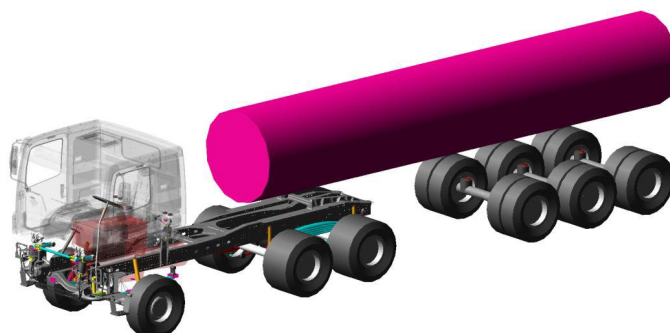
Figura 3 - Modelo completo de veículo com distribuição de carga por eixo de 7,3t, 12,3t, 11,8t e 8t (3x), totalizando 55 toneladas.
