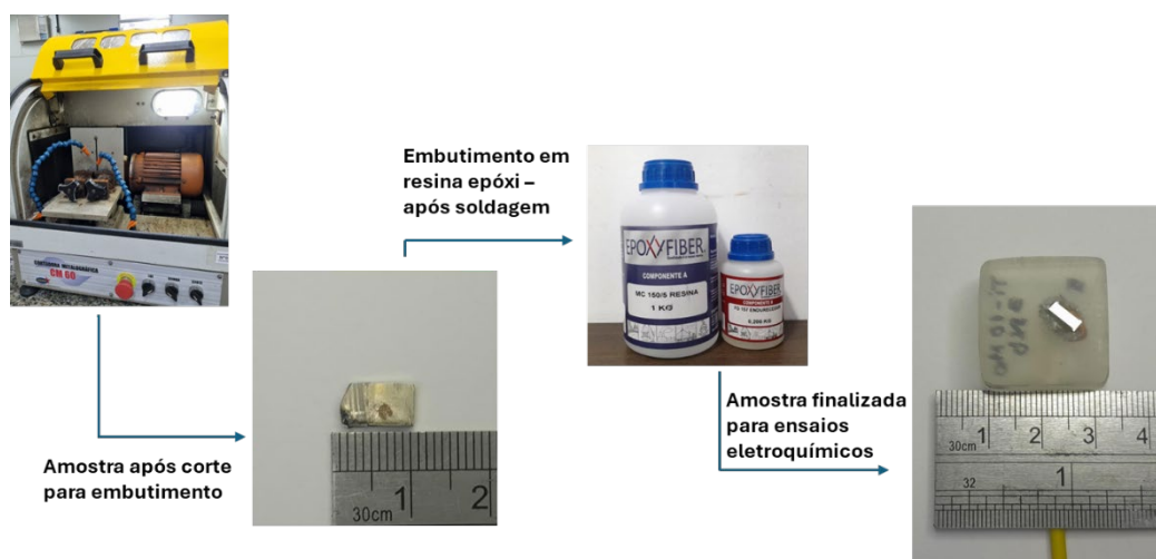
Figura 1: Preparação da amostra para ensaios eletroquímicos.
