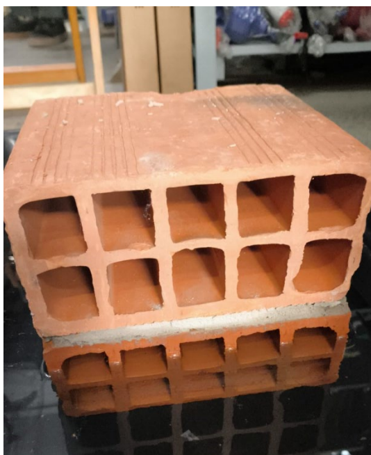
Figura 1- Bloco cerâmico 19x19 assentado com argamassa convencional.
