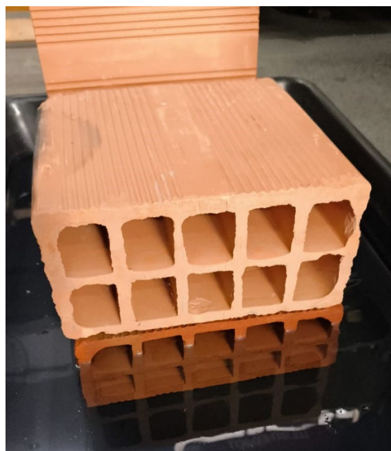
Figura 2- Bloco cerâmico 19x19 assentado com argamassa polimérica. O bloco superior apresenta uma tonalidade uniforme e não mostra sinais de umidade excessiva, indicando que a argamassa polimérica não conseguiu atingir a capilaridade dos tijolos superiores.
