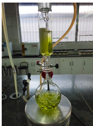
Figura 1 – Refluxo em Soxhlet para extração dos óleos essenciais dos vegetais
