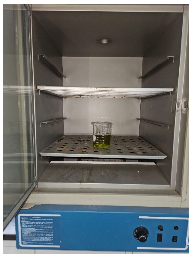
Figura 2 – Secagem em estufa para eliminação do álcool etílico usado para extração dos óleos essenciais
