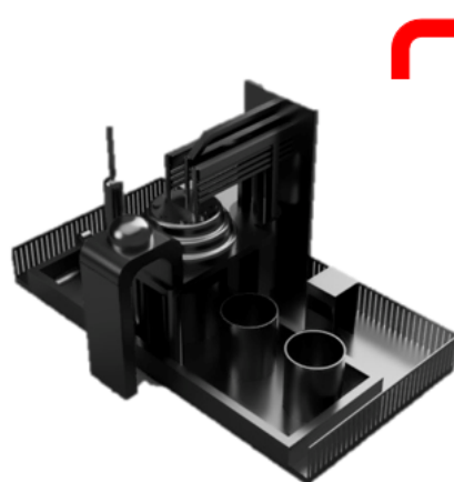
Figura 3 – Forno Elétrico a Arco
