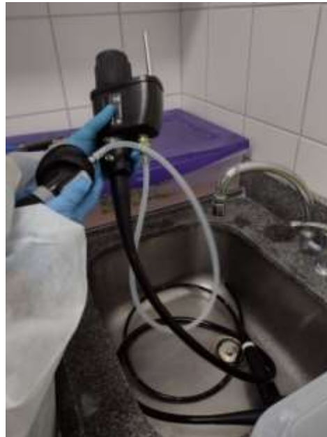
Figura 2 - Teste de estanqueidade (1'10")
