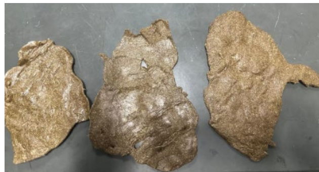
Figura 6 – Mistura de 10% (produto a esquerda) 20% (produto a direita) e 30% (produto central) de PA e fibra mesocárpica de açai.
