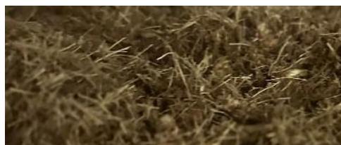
Figura 4 – Mesocarpo após separação.
