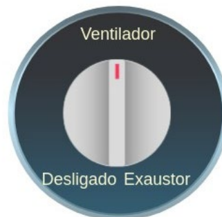
Figura 2 – Chave seletora de modo de trabalho.
